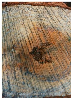
16 **Weichfäule** wird von Mikropilzen verursacht, die Zellulose zersetzen und die Festigkeitseigenschaften des Holzes vermindern. Sie tritt in fortgeschrittener Ausprägung flächig, oftmals zentralisierend auf.
